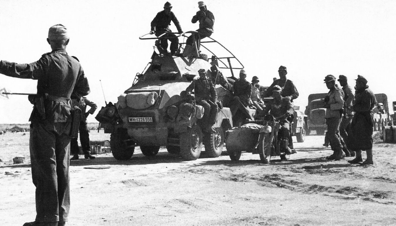
指揮、連絡に多用されたSdkfz.263無線装甲車。高度な機構を採用したため北アフリカでは整備に手間取ることになる
