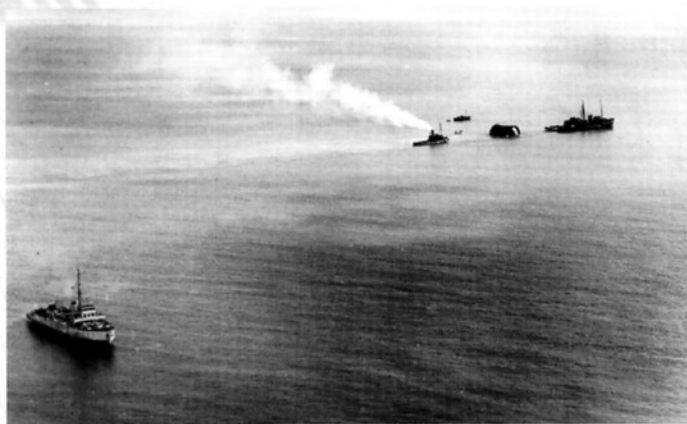
（上段・右）コナン・ドラムとそれを曳航するタグボート。その速度は4〜5ノットとゆっくりしたものだった。（上段左）海底ケーブルの敷設は、ドラム式のほか、改造を加えたケーブル敷設船を用いても行われた。写真はその一隻で、まさに敷設作業中である。
