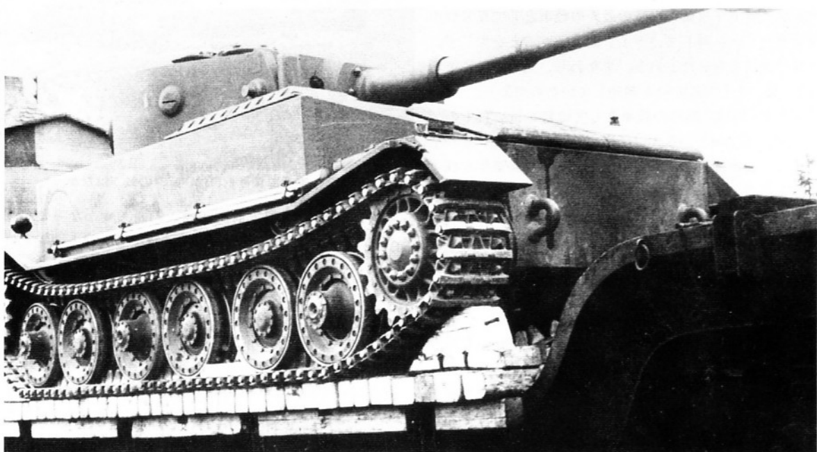
車輛輸送用貨車に載せられたVK4501(P)。本車のエンジンには、ボルシェ博士が開発した電気駆動方式が採用された
