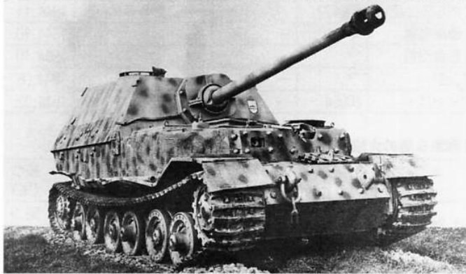
火焰焼入法による表面硬化鋼板を採用したパンターD (上) とフェルジナンド
