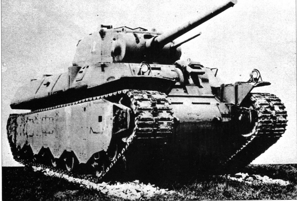
電気駆動式エンジンを搭載したT1E1。採用されてM6A2となった
