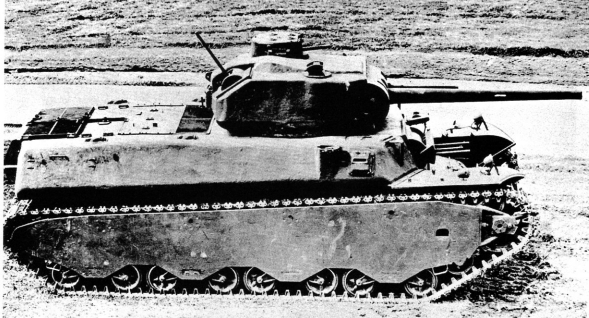
砲塔後部に12.7mm機銃を、また変速機にトルクコンバーターを搭載したT1E2
