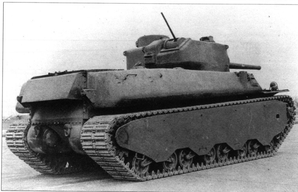
T1E2。砲塔後部右の12.7mm機銃塔は後に撤去されている
