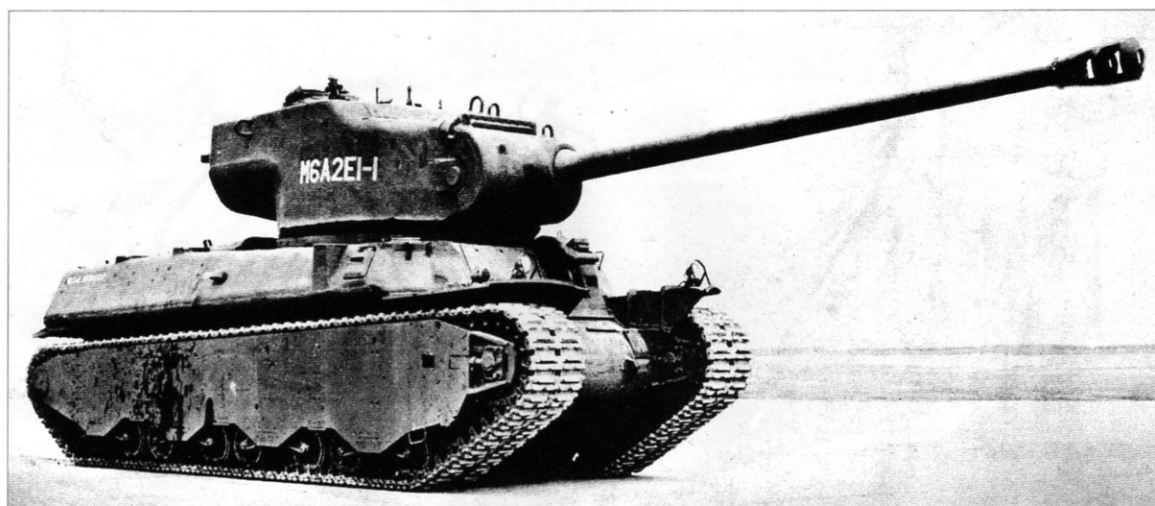
長砲身105mm砲を装備した砲塔をM6A2の車体に搭載したM6A2E1
