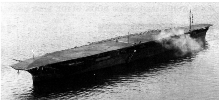
終戦後の昭和20年10月に撮影された鳳翔。新型機の発着艦に対応するために延長された飛行甲板がよく分かる。(NATIONAL ARCHIVES)
