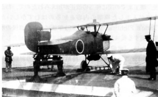
←新造時の鳳翔の飛行甲板。縦索式着艦制動装置の駒板の状況よく分かる。
