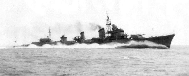
酸素魚雷の存在により雷撃に特化していった日本海軍の軍備は、偏ったものとなった。写真はその象徴ともいえる駆逐艦「島風」。同艦は速度39ノット、5連装魚雷発射管3基という雷撃に特化したフネだった。
