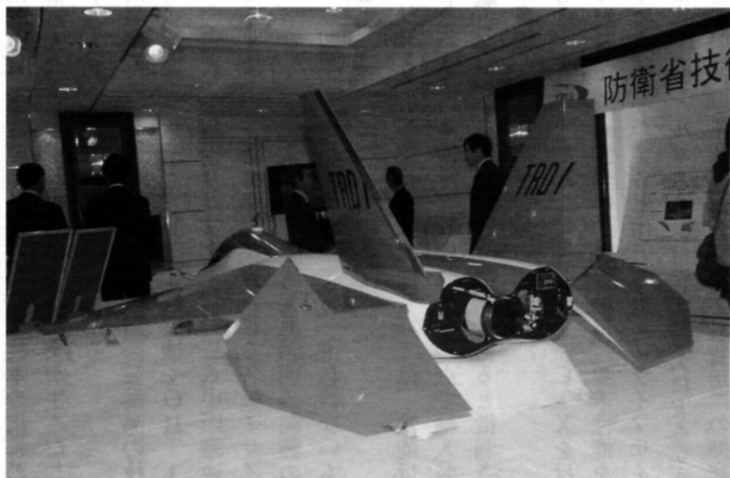
航空機担当が開発する高運動飛行制御システムの5分の1スケールモデル
