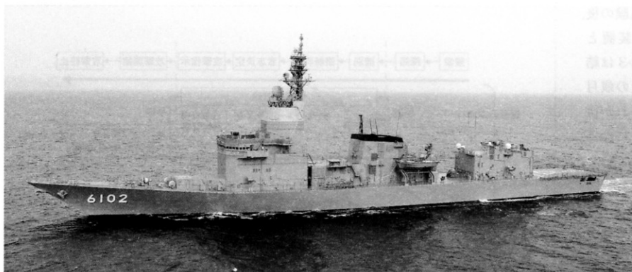
平成7年に就役した試験艦「あすか」。本艦には技術研究本部が試作したFCS-3のCバンド・アンテナが搭載され、約5年にわたる海上試験が行なわれた。(井上 孝司)
