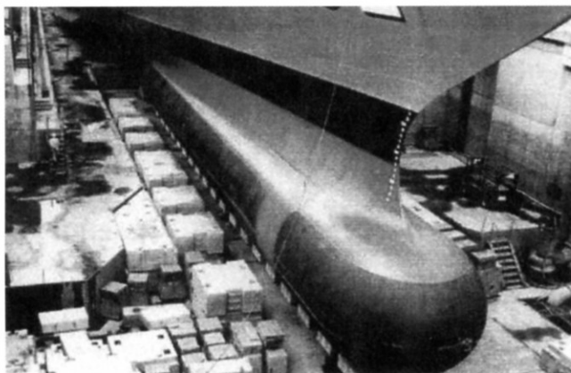
試験艦「あすか」に装備された水上艦用ソナー QQS-XX。(技術資料より)
