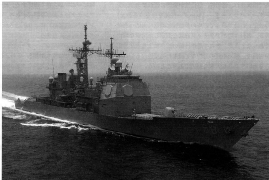
米タイコンデロガ Ticonderoga 級 イージス巡洋艦フィリピン・シー Philippine Sea CG-58。本級が装備するイージス・システムの文字どおり目玉として知られる SPY-1 レーダーは、実用的多機能レーダーの嚆矢ともいえる存在である。（U.S.NAVY）
