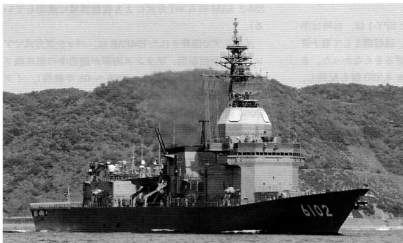
海上自衛隊の試験艦「あすか」。 本艦でテストされたFCS-3は、ポ イント・ディフェンスSAM用に開 発された多機能レーダーで、その 改型が16/18DDHに装備されるほ か、19DDの防空システムの候補 にも挙げられている。(山本 弘敏)
