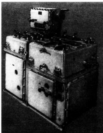
米 Mk37 方位盤用機械式コンピューター Mk 1 の外観 (左) と内部。(Computer Mark 1 and Mods, description and operation, 筆者提供)
