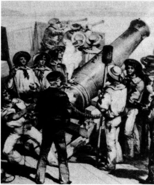
19世紀初頭の艦砲発射シーン。砲尾環にはタンジェント照準器が描かれている。(Guns at Sea)
