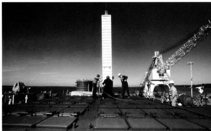
タイコンデロガ級の後部VLSにおけるキャニスターの装填作業シーン。各種ミサイルを発射できるMk41VLSはイージス・システムの重要な構成要素だ。(BAE SYSTEMS)
