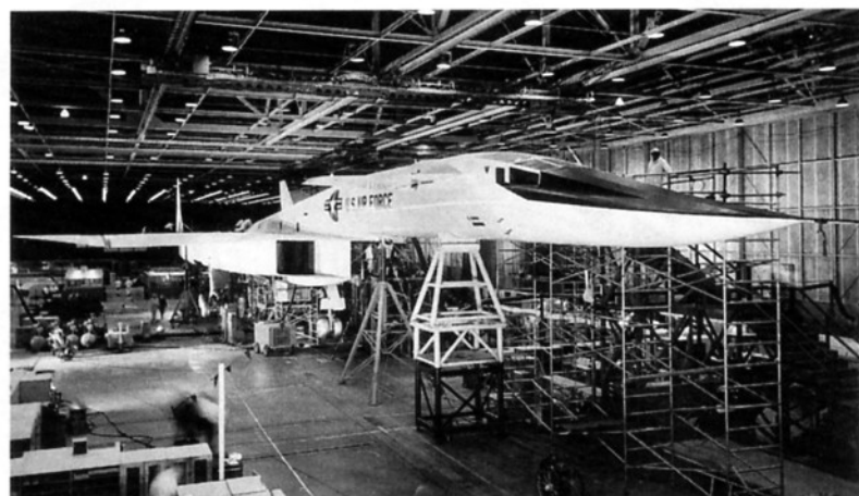
バームデール工場で静止荷重テスト中のXB-70A-1。
