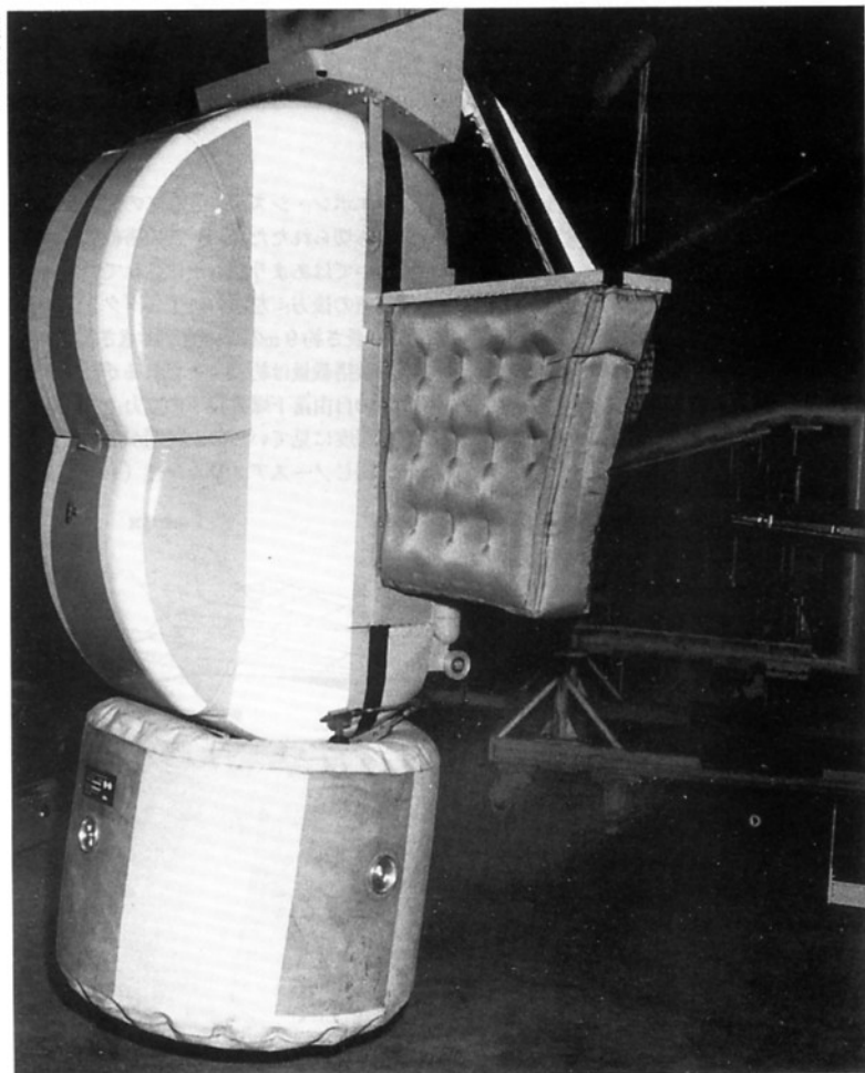
クラムシェル・ドアを閉じた射出後の状態の射出カプセル。マットレスのような張り出しは空力安定フィン。
