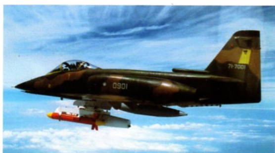
練習機と開発したAT-3を攻撃機型としたAT-3B。写真は標的曳航機材を装着したAT-3B (TaiwanAirPower.org)
