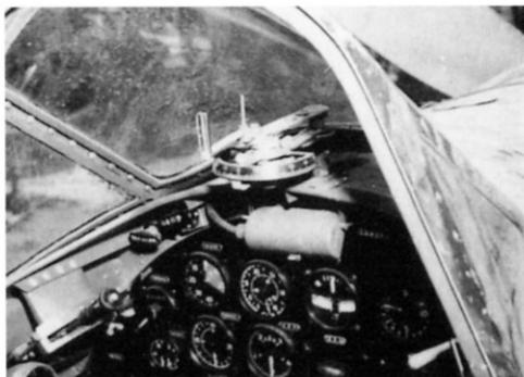
九七式艦上攻撃機の操縦席前方の計器盤に取り付けられた雷撃照準器。雷撃時に航行中の目標（敵艦）の未来位置に対する見越し角を表示する目盛を備えている。
