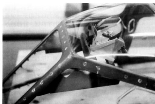
海軍の夜間戦闘機「月光」一型の風防前部上方に装備された三式小型照準器。背後の20ミリ斜銃の射線に合わせて斜めに取り付けられている。
