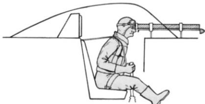
照準器の接眼部に片眼を接しなければならず、空中戦時に周囲への視野が制限され、被弾の危険性が高まる。また照準器の一部（または全部）が機外に露出して大気に晒されるため、レンズの曇り、結露の発生等により、不具合の発生や照準不能になるリスクが大きい。
