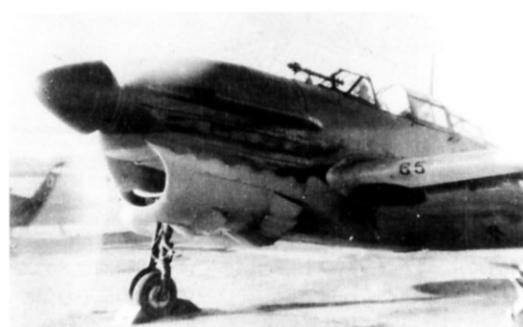
海軍の艦上爆撃機「彗星」の二式一号射爆照準器。九九式艦爆の九五式および九九式射爆照準器との外観上の相違点である対物レンズ部の膨らみがわかる。計算機運動による照準の簡易化を果たしたもの、その効果を充分发挥する機会は得られなかった。
